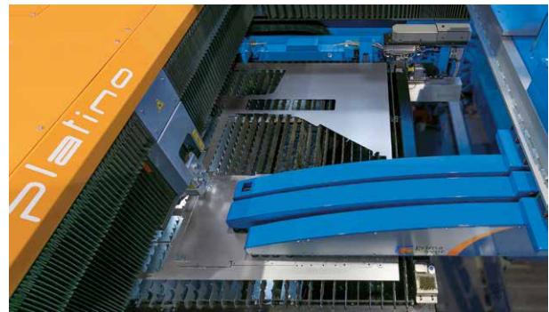
Platinio equipado con LST para la clasificación de piezas y apilado.
