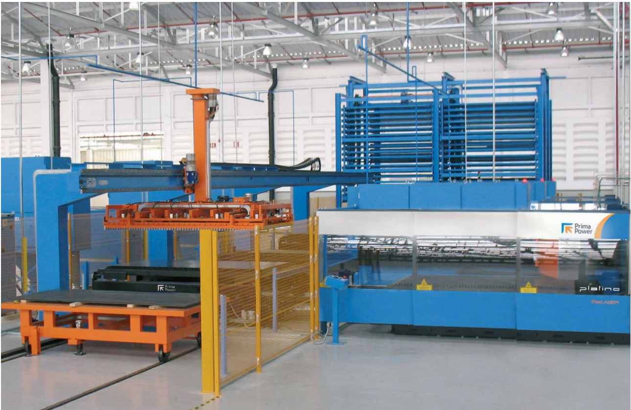
Platinio con manejo automático de materiales y almacenamiento para producción intensiva.
